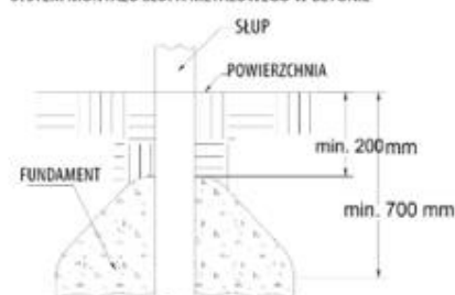
SYSTEM MONTAŻU SŁUPA METALOWEGO W BETONIE
