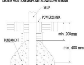
SYSTEM MONTAŻU SŁUPA METALOWEGO W BETONIE
